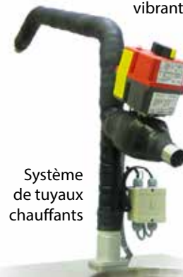
Plaque d'égouttage chauffante avec table vibrante
