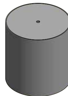
Insert pour réduire le volume dans la cuve
