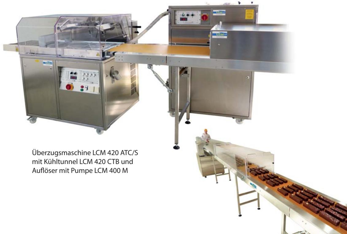
Überzugsmaschine LCM 420 ATC/S
